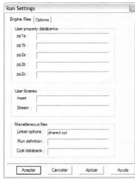
Figura 4.6: Enlazando librerías al servidor
