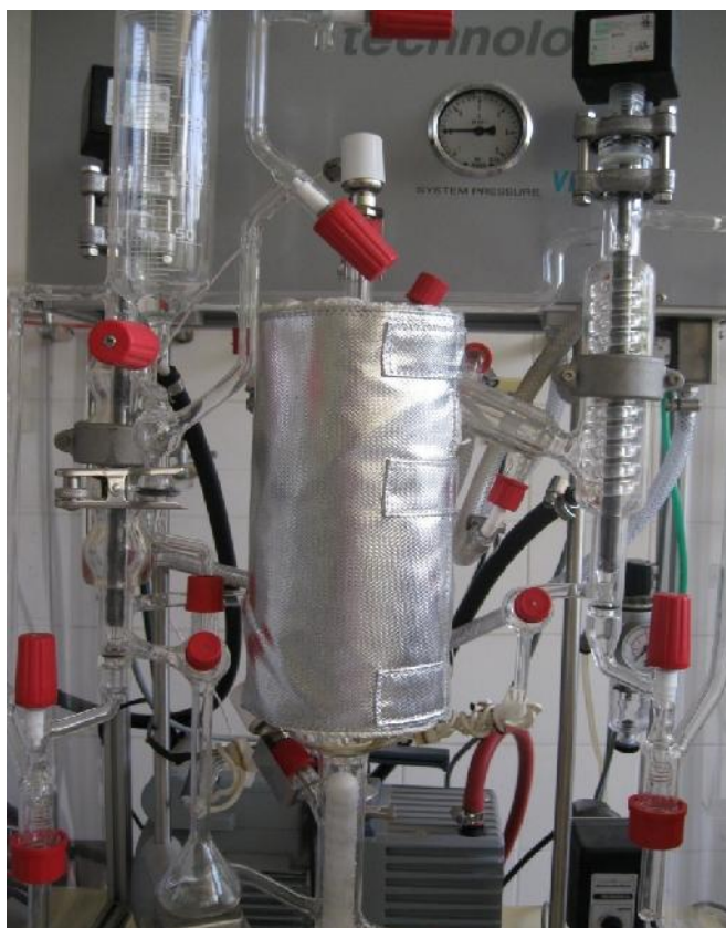
Figura 2.13. Manta calefactora en la columna Cottrell y resistencia en el tubo de condensados.
