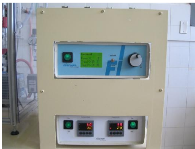
Figura 2.12. Control de temperatura y potencia del calentador de inmersión.
