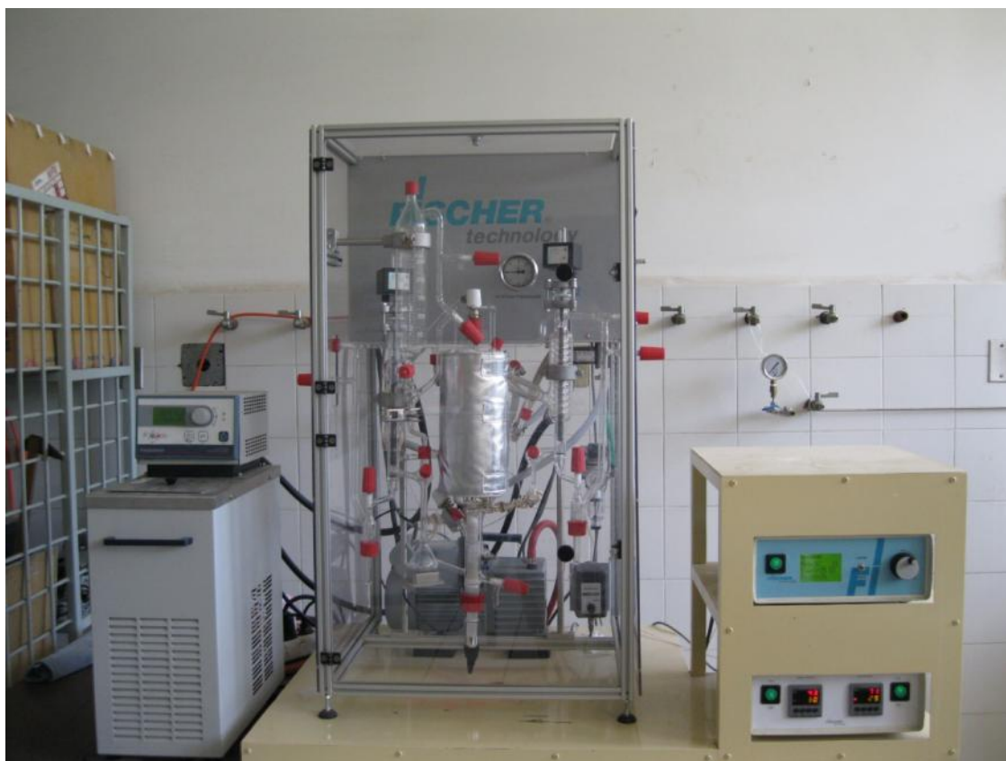
Figura 2.10. Equipo experimental para la determinación del equilibrio vapor-líquido.
