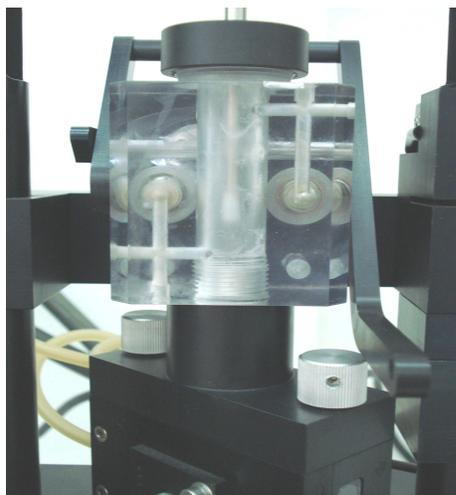
**Figura B.9** Bloque de acrílico acoplado a la celda de medición.
